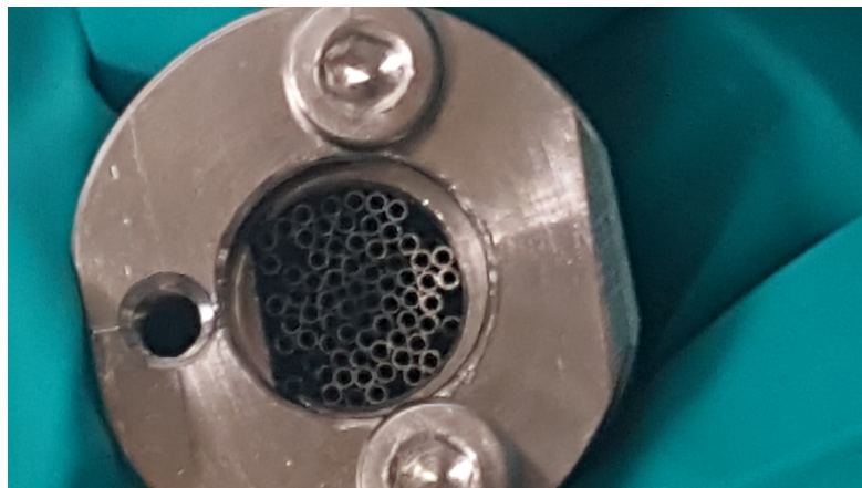
FIGURE 17 – Photographie des micro-tubes lors de l'assemblage du four. Ils sont longs de 15 mm, possèdent un rayon interne de 180 \mu\text{m} et un rayon externe de 250 \mu\text{m} . Le diamètre du berceau est de 4 mm
