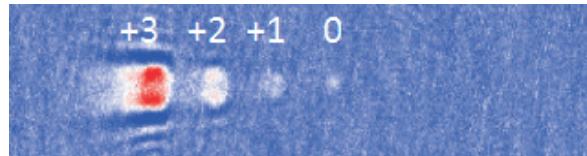
FIGURE 6.4 – Mesure par une procédure de Stern et Gerlach de l'état initial que nous obtenons après la préparation d'état. 85% des atomes sont transférés vers l'état m_S = +3
