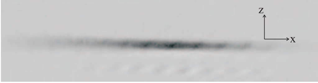
FIG. 7.4 – Densité optique mesurée après 400 ms d'accumulation. L'expansion libre le long de l'axe x est due au temps nécessaire pour éteindre les champs magnétiques après coupure du gradient du piège magnéto-optique.
