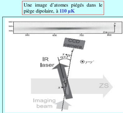
Une image d'atomes piégés dans le piège dipolaire, à  $110\text{ }\mu\text{K}$
