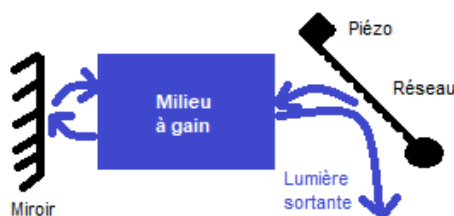
FIGURE 31 – Schéma du milieu amplificateur d'une diode LASER
