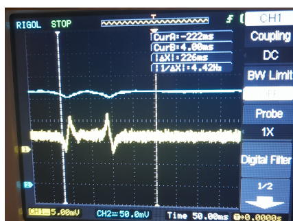
FIGURE 26 – Premier signal d'erreur de spectroscopie d'absorption saturée
