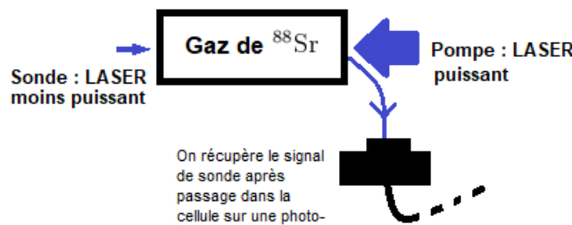
FIGURE 19 – Principe de la spectroscopie d'absorption saturée
