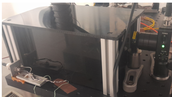
FIGURE 18 – Protection de la cavité par une boîte de plexiglas
